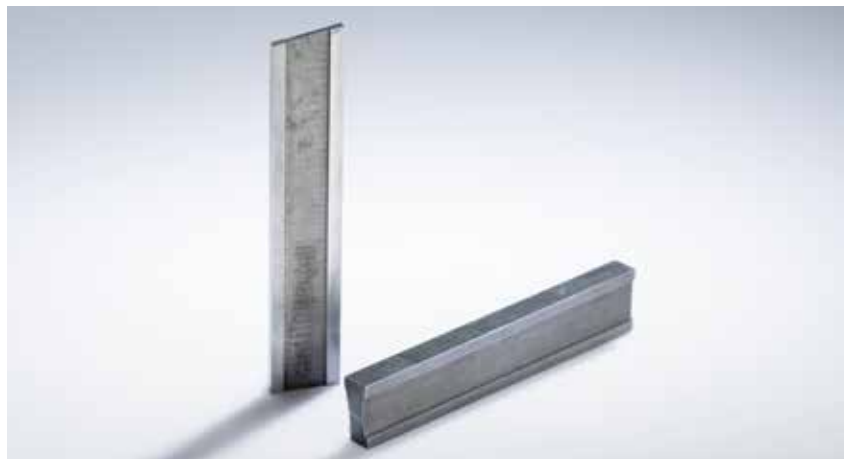
Оригинальный твердосплавный канавочный резец 1969 года
