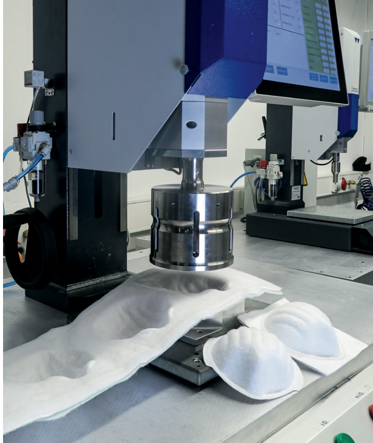
Процесс ультразвуковой сварки от компании Weber Ultrasonics используется для изготовления хирургических масок
