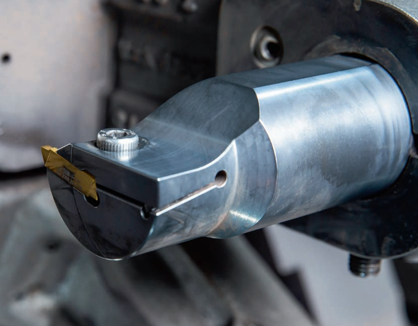
Державка 213 и режущая пластина S229.
