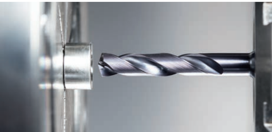
Сверление головки винта с помощью системы HORN DD.
