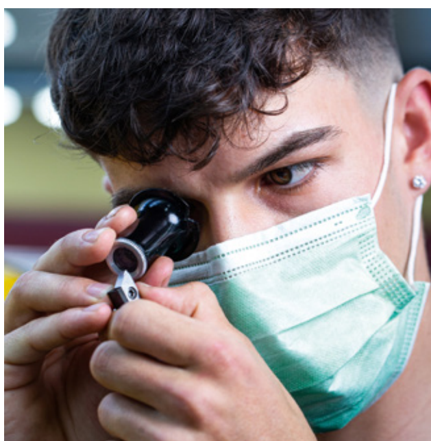
Проверка состояния режущих кромок после обработки 22 500 профилей
