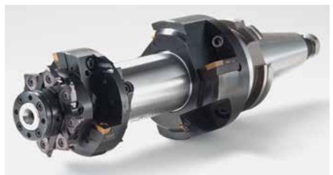
Kombiwerkzeuge sparen bei der Serienfertigung Haupt- und Nebenzeiten.
