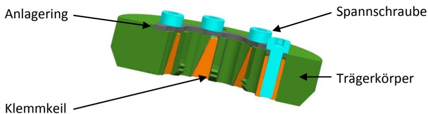
Nach der Montage von Trägerkörper und Klemmkeilen können die Schneidplatten eingesetzt werden. Hierbei muss die Nummerierung der Schneidplatten mit der des Plattensitzes übereinstimmen. Die erste Ziffer steht für den Plattensitz, die zweite für die Anzahl der Schneiden in dem Satz.
