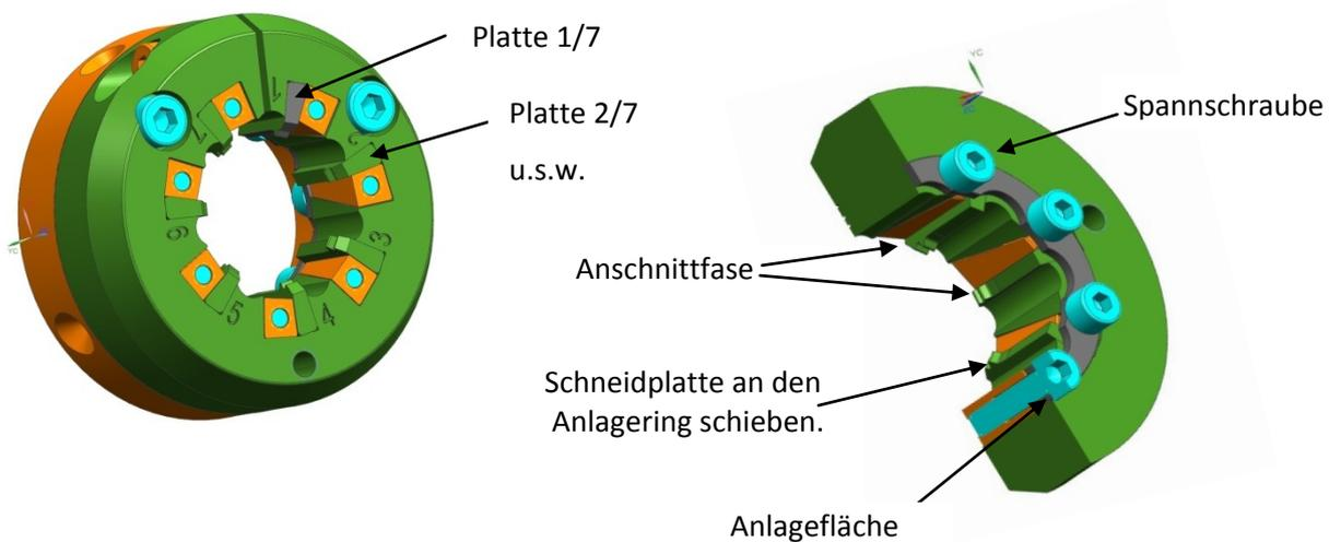
Z. B. beginnt man mit der Nummer 1/7 im Plattensitz 1. Dann Nummer 2/7 im Plattensitz 2 u.s.w. Mit leichtem Druck auf die Spanschraube lässt sich der Anlagering plan auf die Anlagefläche drücken.
