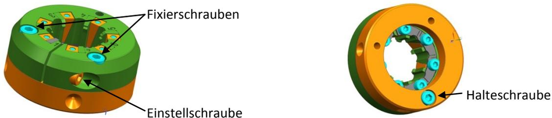
1. Fixierschrauben herausdrehen und Einstellschraube lösen
