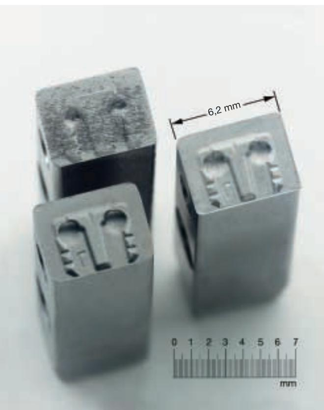
Durch Mikrofräsen hergestellte Geometriestempel für Wendschneidplatten der Typen S 224 und S 229
