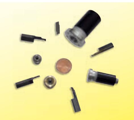
Das Bild zeigt eine Auswahl der bei maxon motor gefertigten Bauteile für Getriebemotoren und die zum Einsatz kommenden Supermini-HM-Sonderwerkzeuge
