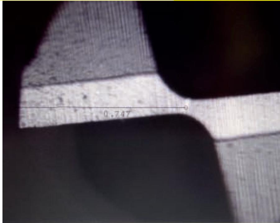
Innenradius der Spankammer eines Mikrofräsers 0,2 mm in der Draufsicht
