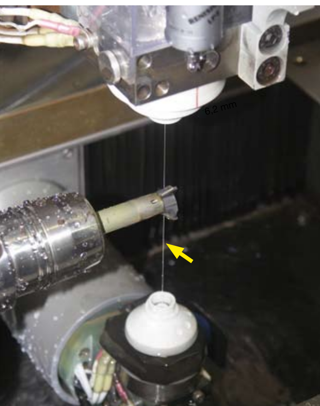
Erodieren eines CBN-Sonderwerkzeuges. Der Durchmesser des Schneiddrahtes beträgt 0,03 mm
