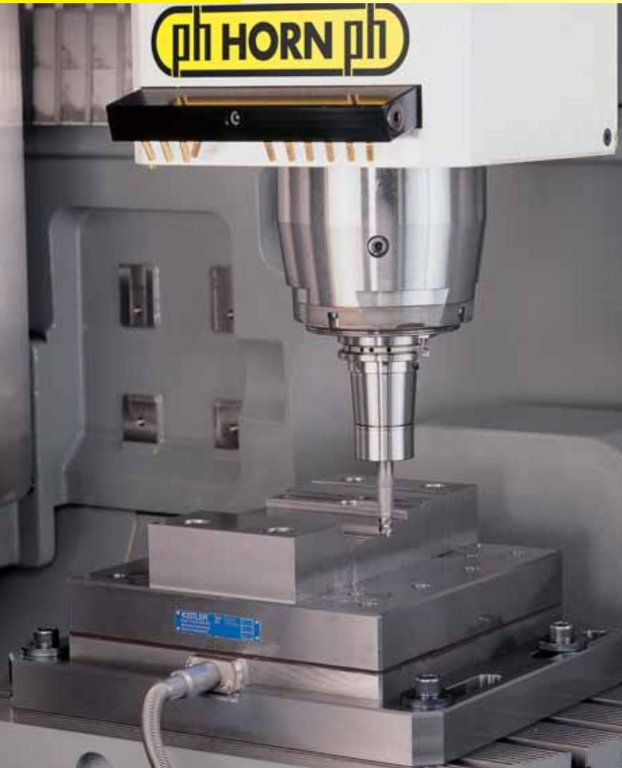
Versuchsanordnung zum Messen der Radial- und Axialkräfte an einem Schafffräser mit Hilfe einer Dreikomponenten-Messplattform.
