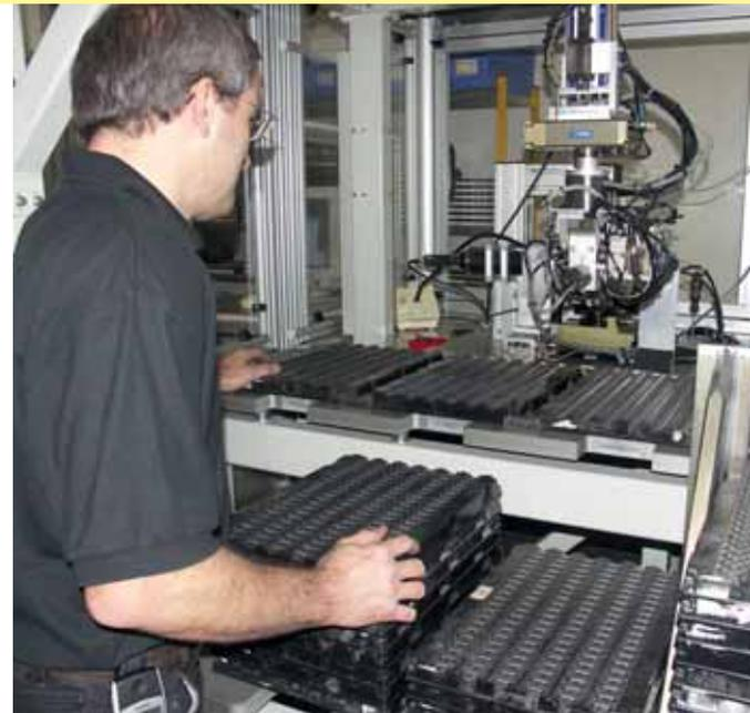
Automatisch arbeitende Messmaschinen prüfen jede Hartmetallplatte auf Maßgenauigkeit.
