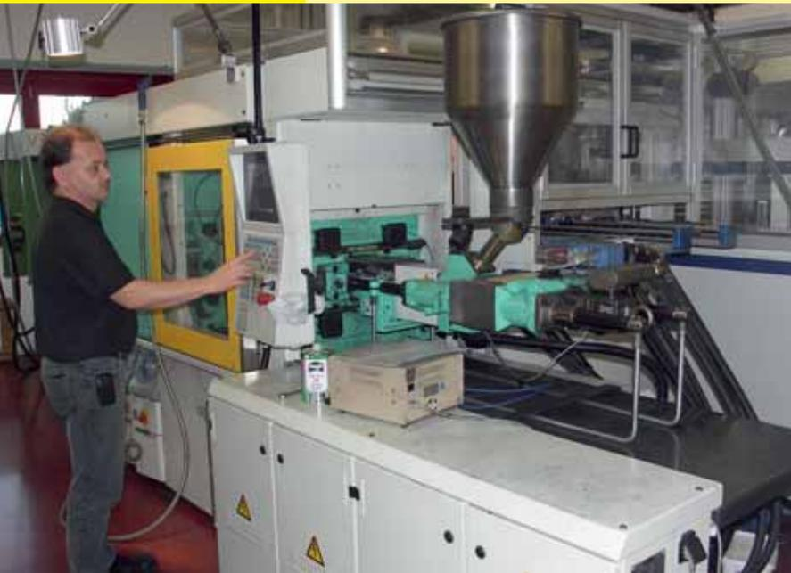
Beim Spritzgießen wird das Hartmetallgemisch in eine Form gespritzt. Nach dem Öffnen der Form entnimmt ein Greifer den Rohling und legt ihn auf einer Graphitplatte ab.
