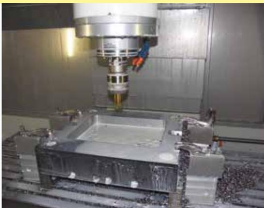
Die 230 x 250 mm große Tasche eines Spritzgießwerkzeugs wird zuerst trocken (Bild links) auf 5 mm und danach nass bis 44 mm Tiefe (Bild rechts) mit einem Fräser DAH 32 mm Durchmesser geschruppt.
