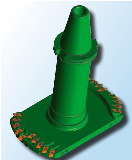
Modellansicht des Brückenwerkzeugs. Schneidkreisdurchmesser 262 mm, Brückenbreite 114 mm, Werkzeugaufnahme SK 50 DIN 69871-B mit Innenkühlung, Auskragung etwa 230 mm.
