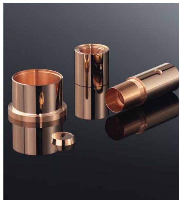
Arbeitsbeispiel Schreibgerät. Ein Konturstechwerkzeug und ein Formwerkzeug erzeugen die verschieden geformten Einstiche.
