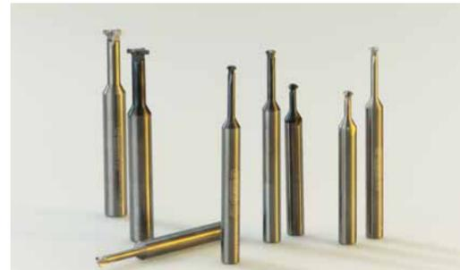
schneider speziell beim Bearbeiten von Werkstoffen für die Medizintechnik wie Kobalt-Chrom-Stählen, Titan, rostfreien Stählen und Kunststoff. Besonders vorteilhaft ist die exakte Definitionsmöglichkeit des Gewindeein- und -auslaufs sowie der Gewindetiefe beim Fräsen oder Wirbeln von Innengewinden. Die Fräser DCG sind standardmäßig bis zu einer Gewindelänge von 3 x D lieferbar.
