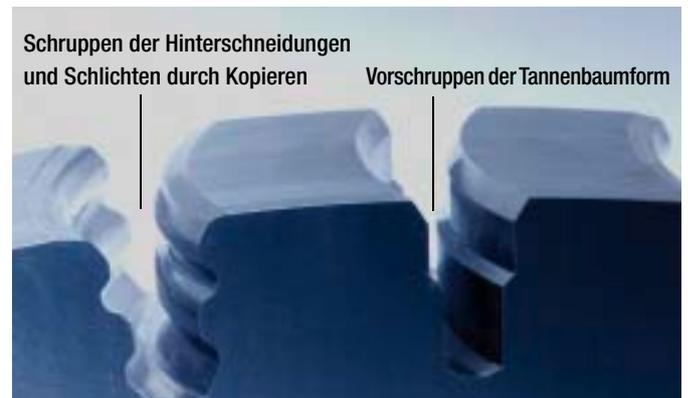
Bearbeitung der Schaufelfüße. Rechts: Schruppen mit Schneidplatte S229. Links: Fräsen der Hinterschneidungen mit Fräser 308 und abschließendes Kopieren der Tannenbaumform mit Schneidplatte S229.
