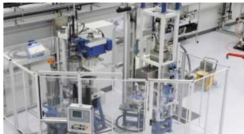
Isostatische Presse (links) mit Füllturm (rechts).
