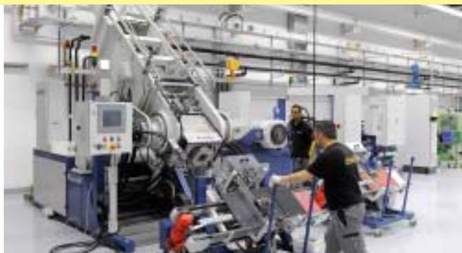
Ein Mitarbeiter fährt eine Automatisierungseinrichtung zu der neuen Kolbenstangenpresse.
