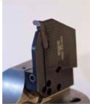
Kassette K220 mit hakenförmiger Stechplatte S229. Als Trägerwerkzeug dient ein von Trevisan entwickelter Grundhalter.
