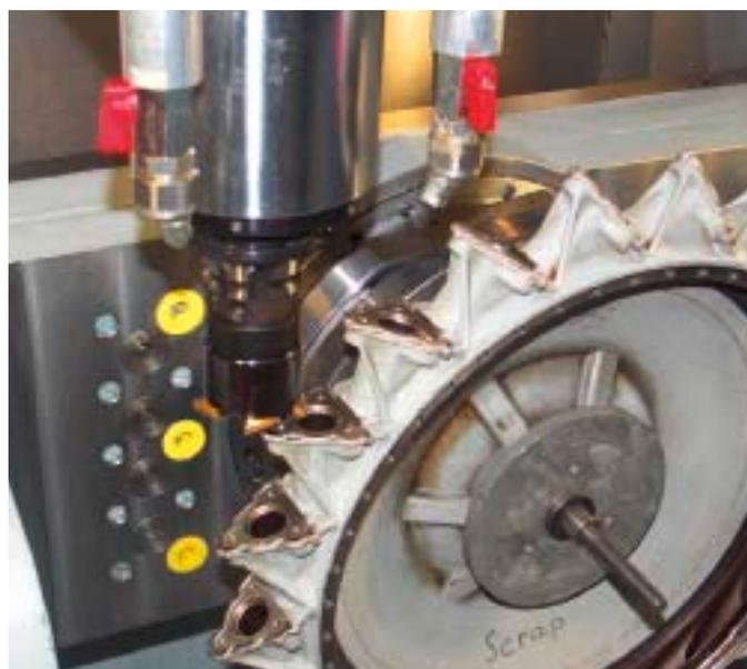
Ein als Messerkopf eingesetzter Nutfräser mit Schneidplatten aus dem System 314 fräst bei Wartungsarbeiten an Flugzeugturbinen die aufgespritzte Ni-Schicht am Niederdruck-Verteiler auf Maß.
