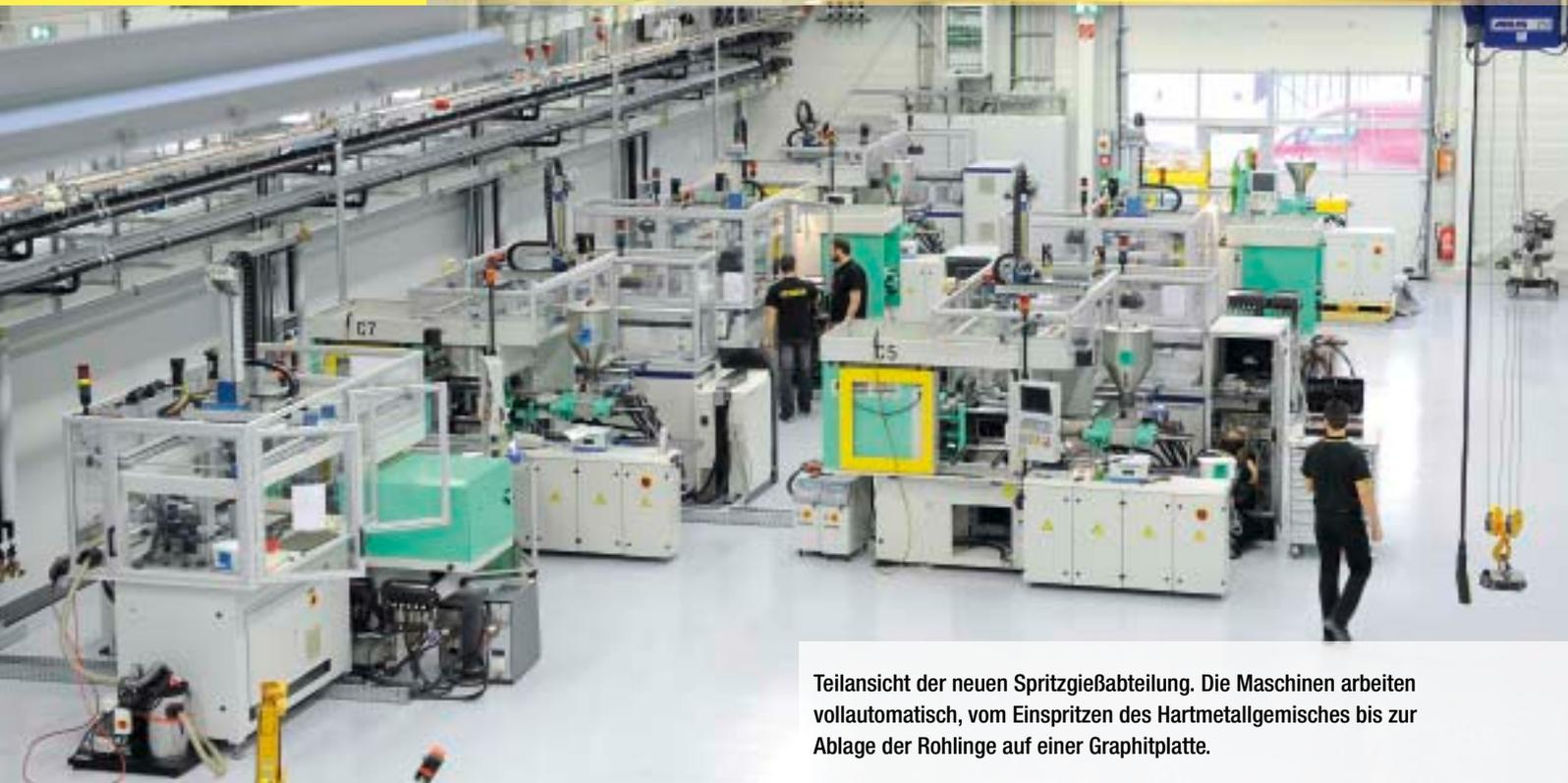
Teilansicht der neuen Spritzgießabteilung. Die Maschinen arbeiten vollautomatisch, vom Einspritzen des Hartmetallgemisches bis zur Ablage der Rohlinge auf einer Graphitplatte.
