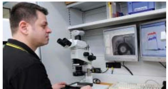
An Stereo-Mikroskopen werden versuchsbedingte Veränderungen an den Schneiden analysiert und dokumentiert.
