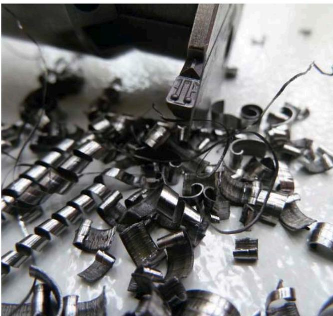
Die L-Geometrie sorgt für prozesssicheren Spanbruch bei Inneneinstichen.
