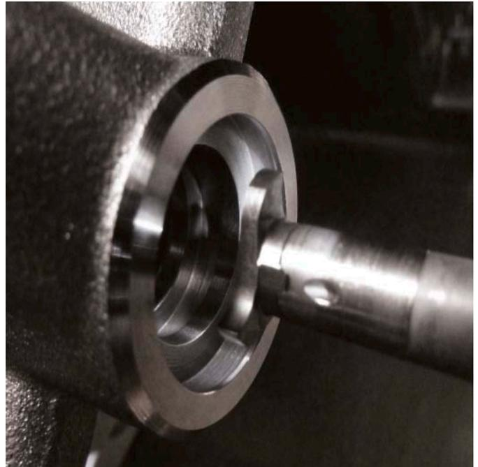
Mit dem Zirkularfräser vom Typ 308 mit langer Auskragung erfolgt der Arbeitsschritt Vorfräsen.
