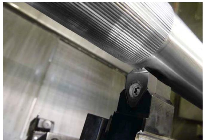
Mit der Stoßplatte S117 werden drei Rändelzähne mit einer Zahnhöhe von 0,4 mm gestoßen – dreimal so schnell wie bisher.
