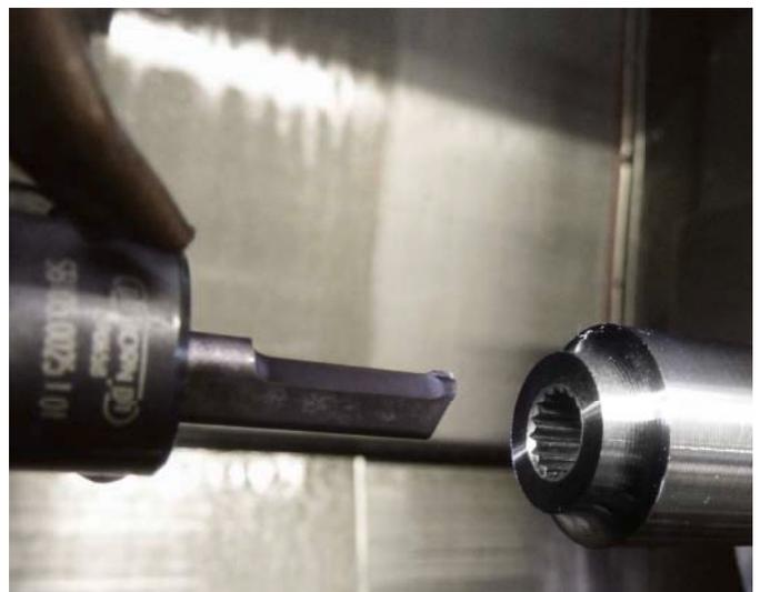
Die Zähne der Innenverzahnung werden mit einer Sonderplatte des Typs 105 in drei Zustellungen auf eine Zahnprofiltiefe von 0,6 mm gestoßen.
