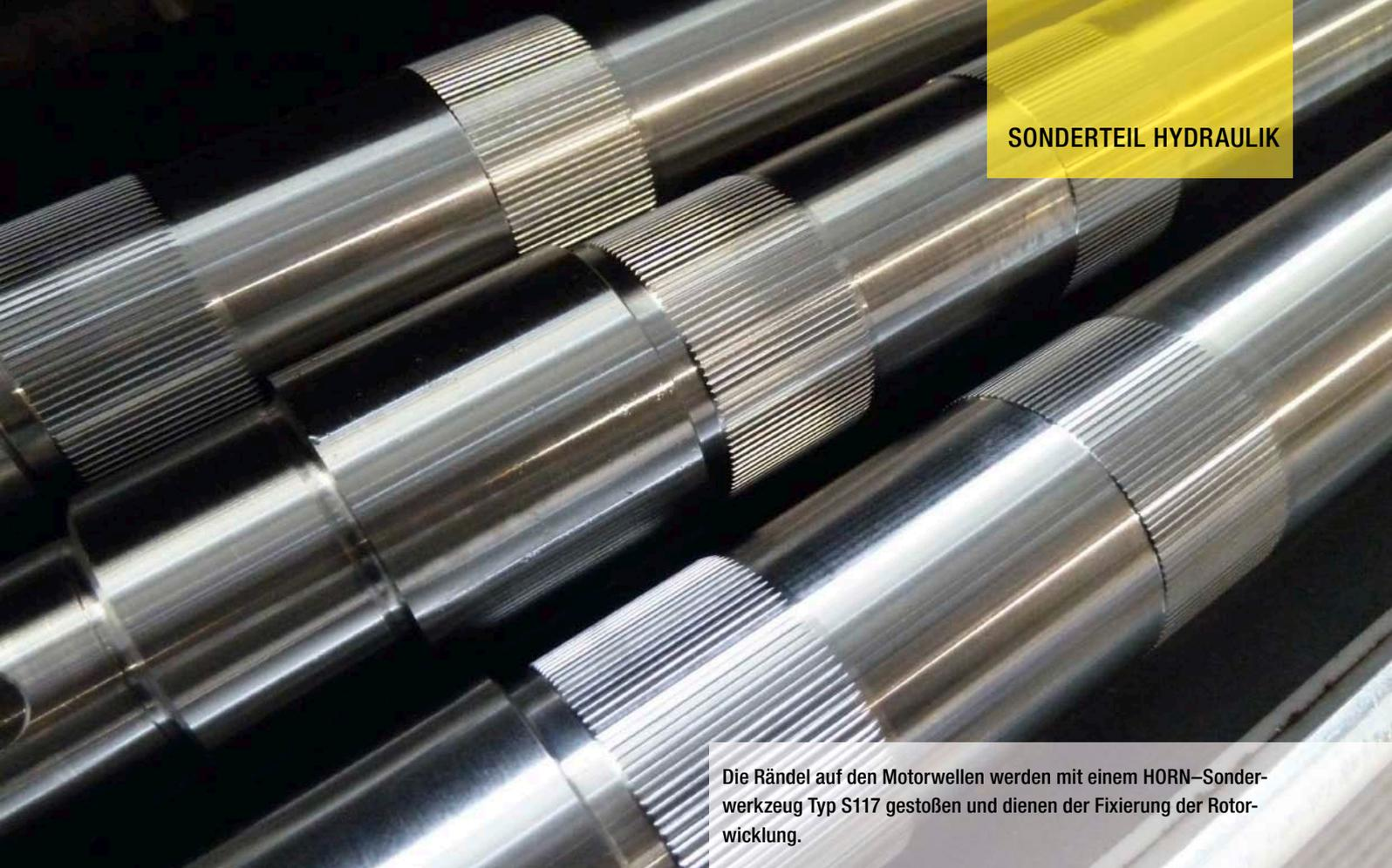
Die Rändel auf den Motorwellen werden mit einem HORN-Sonderwerkzeug Typ S117 gestoßen und dienen der Fixierung der Rotorwicklung.
