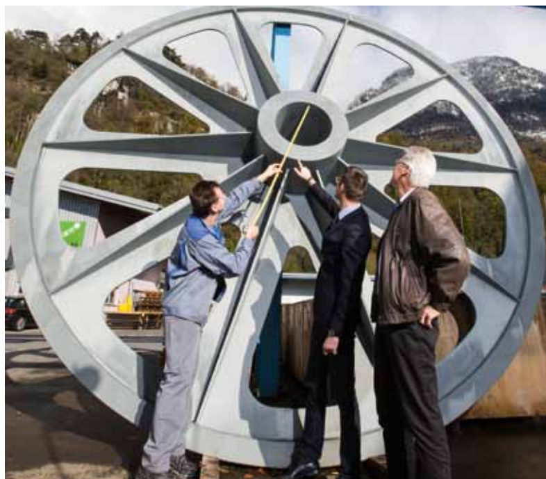
Antriebsrad mit 6 Meter Durchmesser für eine Seilbahn. Für Edi Hurschler (links) von der Großbearbeitungs AG ist diese beeindruckende Größe normal, für Christian Thiele von HORN (Mitte) und Wilfried Iseppi von Dihawag (rechts) nicht unbedingt.
