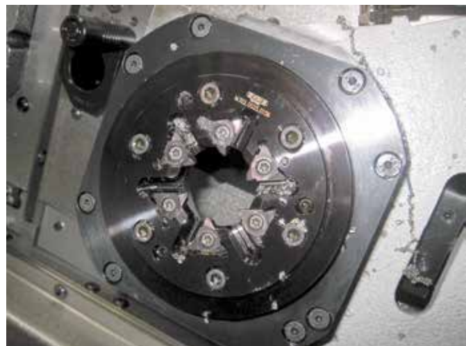
Wirbelkopf Typ M302 mit sechs Schneiden, montiert auf der Wirbeleinrichtung eines Drehautomaten
