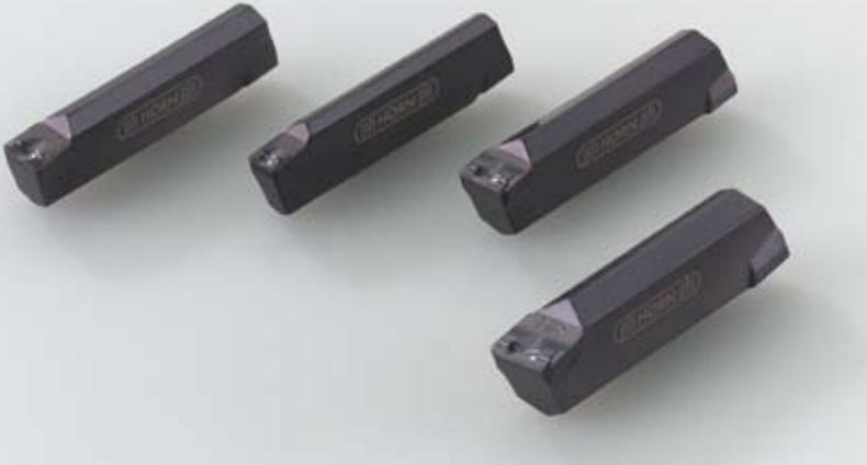
„HR-Geometrie“ (hard roughing) ist unsere Lösung zum Vermeiden von Wirrspänen. Die treppenförmige Spanfläche und Spanformrille erzeugt die gewünschten kurzen Späne beim Abfließen. Ausführliche Informationen dazu auf Seite 17.
