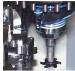
Bild oben: Mit dem Nutfräser 636 werden die Nuten in die beiden Maulteile gefräst.
