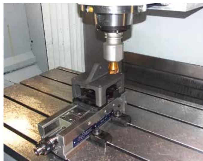
Der Hochvorschubfräser DAH schruppt das Bracket aus dem Vollen aus Werkstoff 1.4542. Abschließend schlichtet ein Fräser des Systems DA die Oberfläche.
