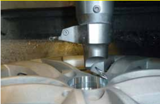
Kombihalter zur Außen- und Kappenbearbeitung.
