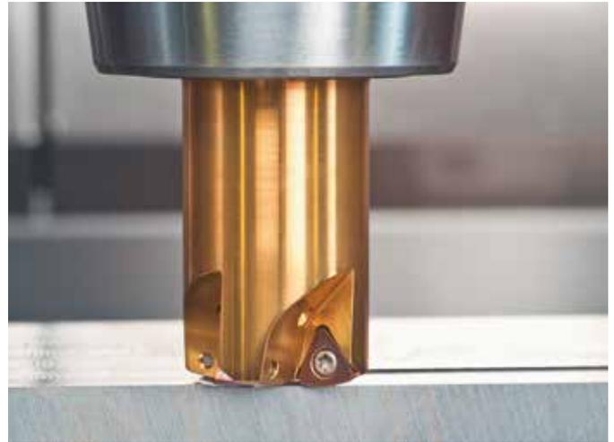
Hochvorschubfräsen mit System DAH für geometrisch anspruchsvolle Bauteile aus Titan.
