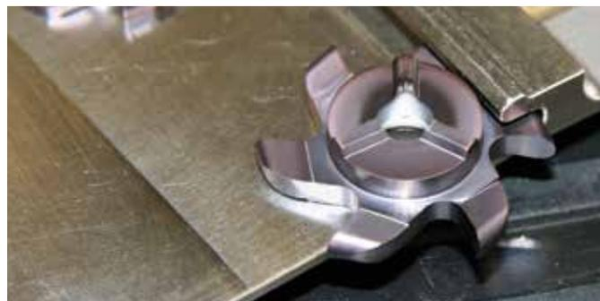
Die 6 mm tiefe Nut wird in einem Zug auf Mittelpunktsbahn bis auf 5,9 mm Tiefe geschrumpft.
