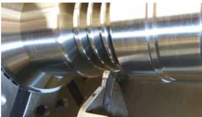
Die tiefen Einstiche der Kühlrippen werden heute mit einer Lösung von HORN in einer Operation mit demselben Werkzeug geschruppt und geschlichtet.
