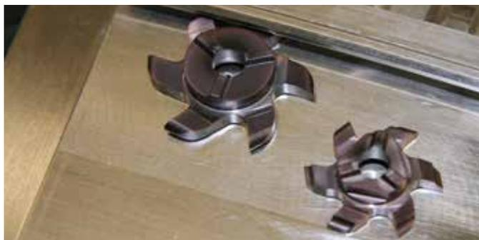
Ein HORN Zirkularfräser Typ 628 schrumpft die Nut, sein identischer Bruder schlichtet sie, ein weiterer Zirkularfräser erzeugt eine exakte Kantenverrundung.
