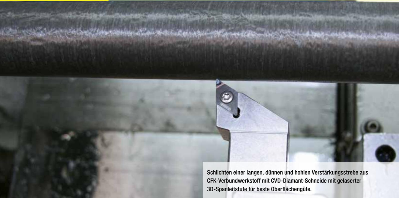
Schichten einer langen, dünnen und hohlen Verstärkungsstrebe aus CFK-Verbundwerkstoff mit CVD-Diamant-Schneide mit gelasierter 3D-Spanleitstufe für beste Oberflächengüte.
