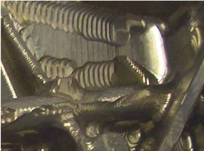
Ausschnitt des Gehäusedeckels auf der Vorderseite nach dem Schruppen mit dem Kugelfräser. Der Rest des Teiles ist geheim.
