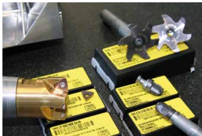
Drei Hochleistungsfräser von HORN mit extremen Standzeiten in Titan: einer fürs Volumen, einer für die Konturen und einer für Hinterschnitte.
