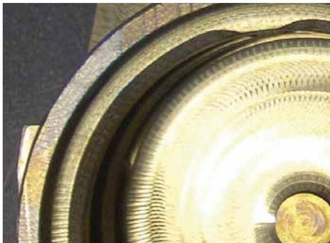
In einer tiefen runden Kavität werden mit einem HORN-Nutenfräser vom Typ 636 mehrere Hinterschnitte eingefräst. Standzeit: zehn Teile mit jeweils mehreren Hinterschnitten.
