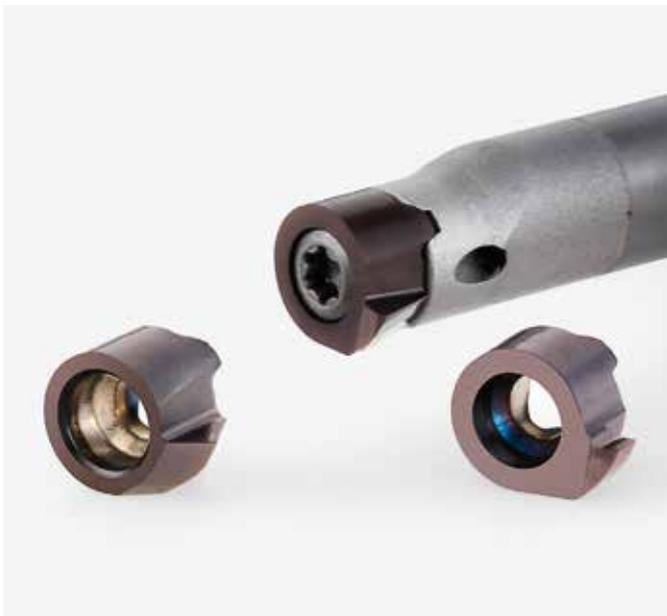
Schneidplatte Mini 106 zum Ausdrehen und Einstechen ab Ø 6 mm.
