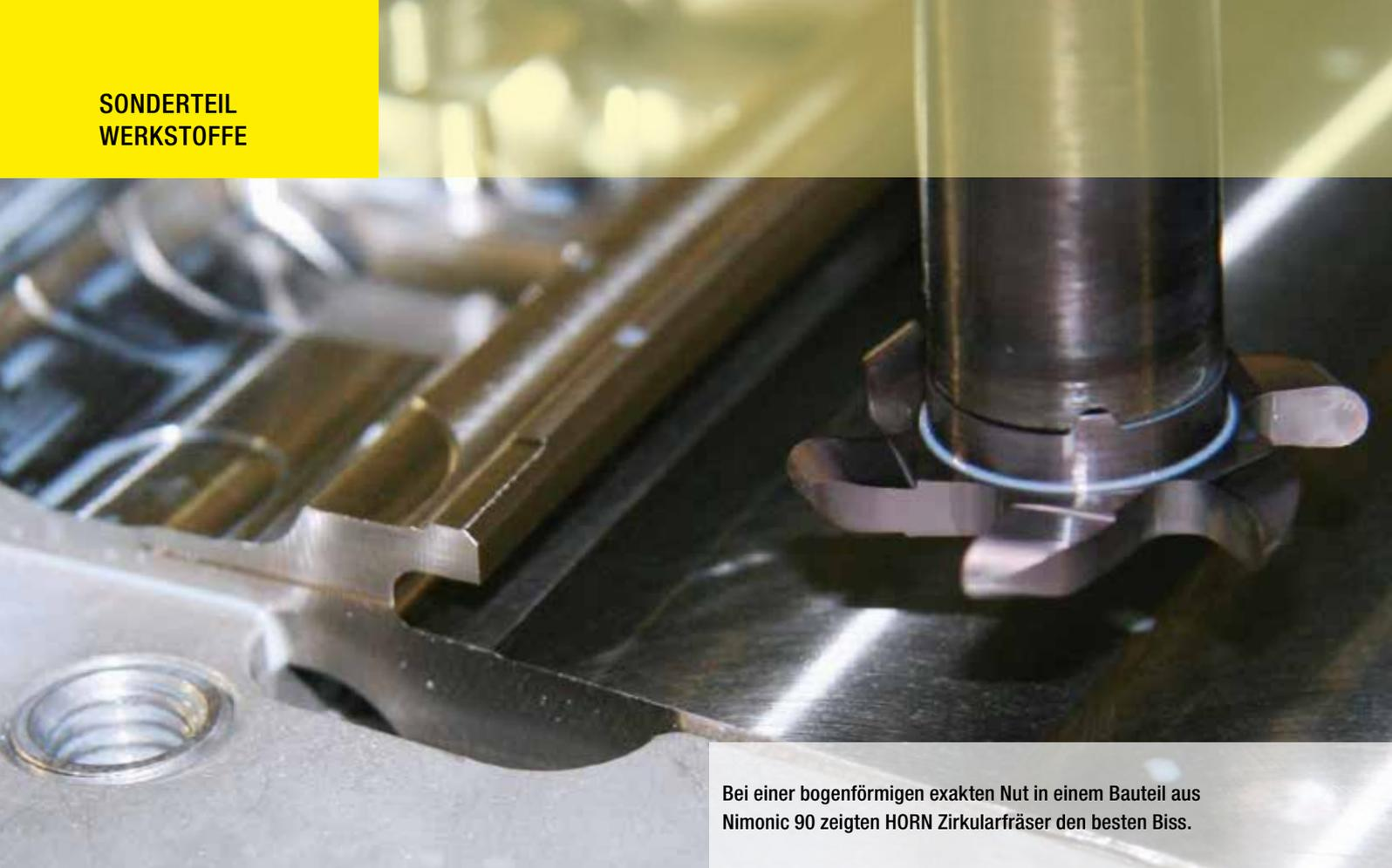
Bei einer bogenförmigen exakten Nut in einem Bauteil aus Nimonic 90 zeigten HORN Zirkularfräser den besten Biss.
