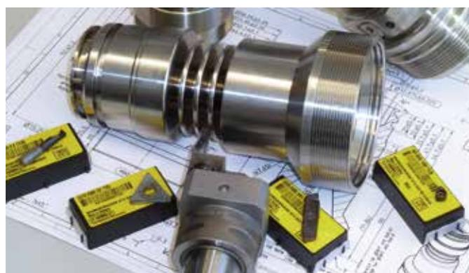
An der umfangreichen Bearbeitung eines Werkstücks aus rostfreiem Edelstahl sind allein fünf Werkzeuge von HORN an den entscheidenden Operationen beteiligt – eines davon mit Standard- und Sonderplatte.
