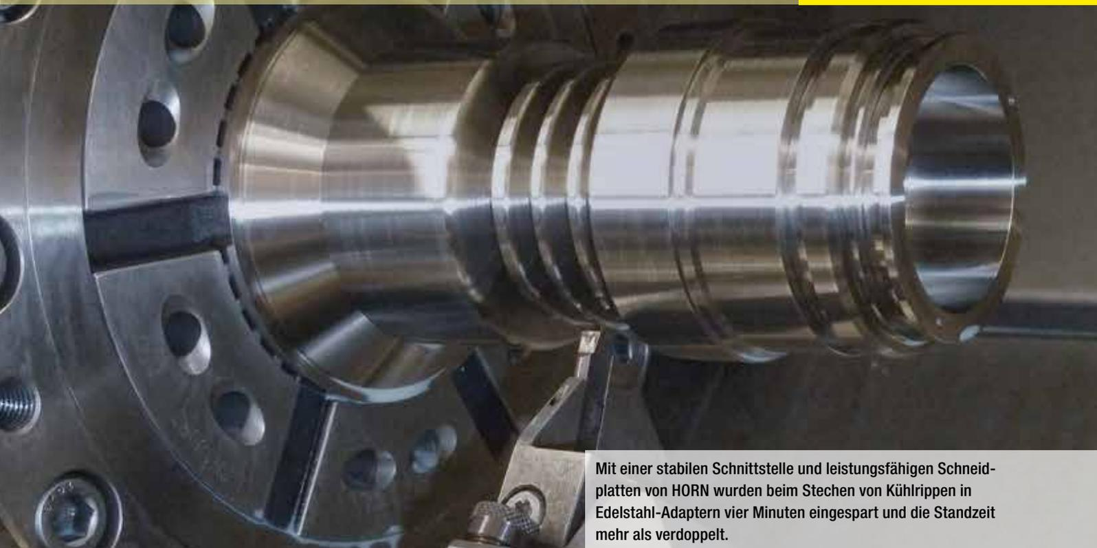
Mit einer stabilen Schnittstelle und leistungsfähigen Schneidplatten von HORN wurden beim Stechen von Kühlrippen in Edelstahl-Adaptern vier Minuten eingespart und die Standzeit mehr als verdoppelt.
