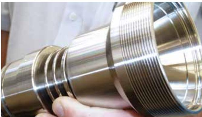
Der innen liegende Konus und die Kühlrippen sind die heiklen Operationen an diesem Bauteil. Beide wurden durch HORN-Werkzeuge entscheidend verbessert.
