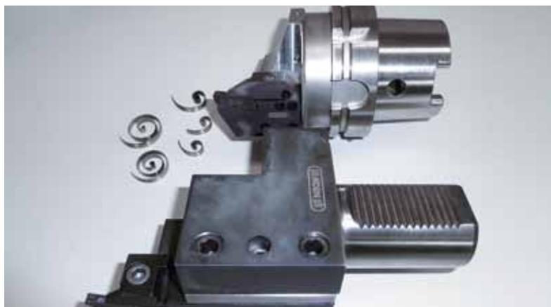
Zwei Systeme mit IK: Der HSK-100-Grundkörper mit Kassettensystem ist adaptiert an der Dreh-Bohr-Fräs-Einheit, der VDI-Halter am Revolver. Beide sorgen für kurze kontrollierte Späne.
