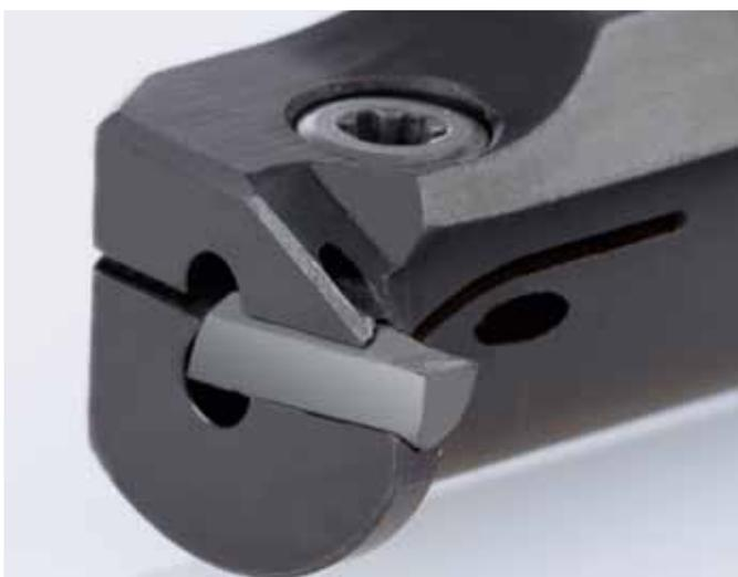
Kühlmittelzufuhr über Spannfinger und zusätzlicher Bohrung im Schaft/Hals für maximale Standzeiten und effektiven Spänetransport.
