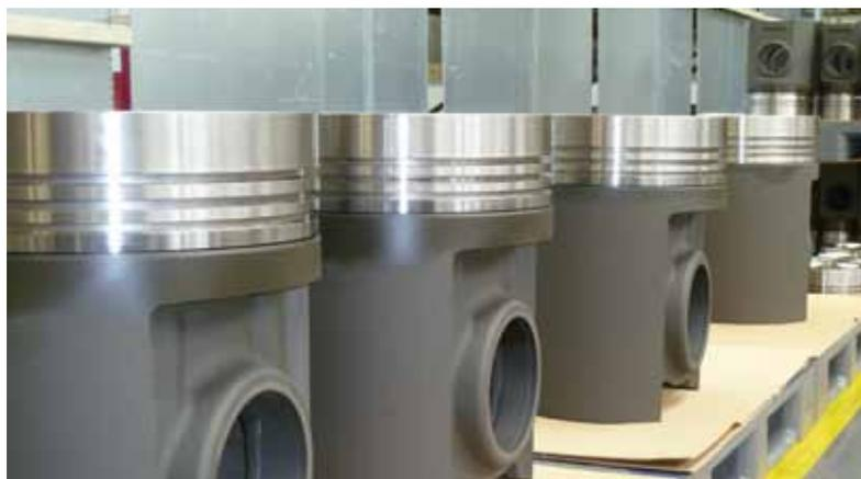
Die Partnerschaft zwischen KS Kolbenschmidt und HORN bei der Bearbeitung der Kolbenringnuten für Großkolben führte zur Entwicklung der Hochdruck-Innenkühlung.
