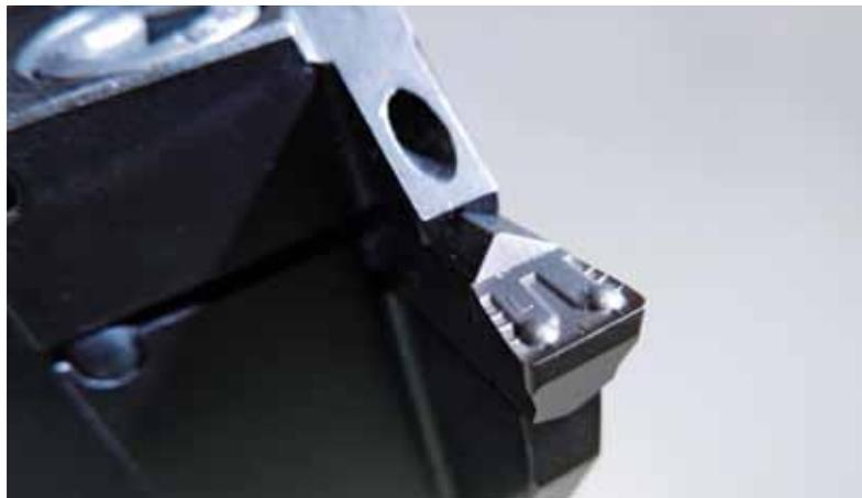
Der Klemmhalter vom Typ 218 am VDI-Halter, bestückt mit Wendeschneidplattentyp S229 mit Geometrie „L“, kommt beim Vorstechen zum Einsatz.
