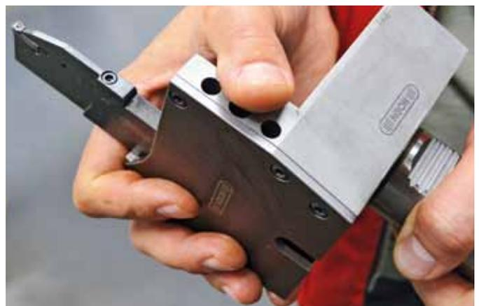
Die Schneidplatte S100 mit Innenkühlung ist in einer prismatischen Aufnahme mit Schraubenklemmung prozesssicher fixiert. Stechtiefe der Ausführung von febi bilstein bei 4 mm Schneidenbreite bis zu 45 mm.
