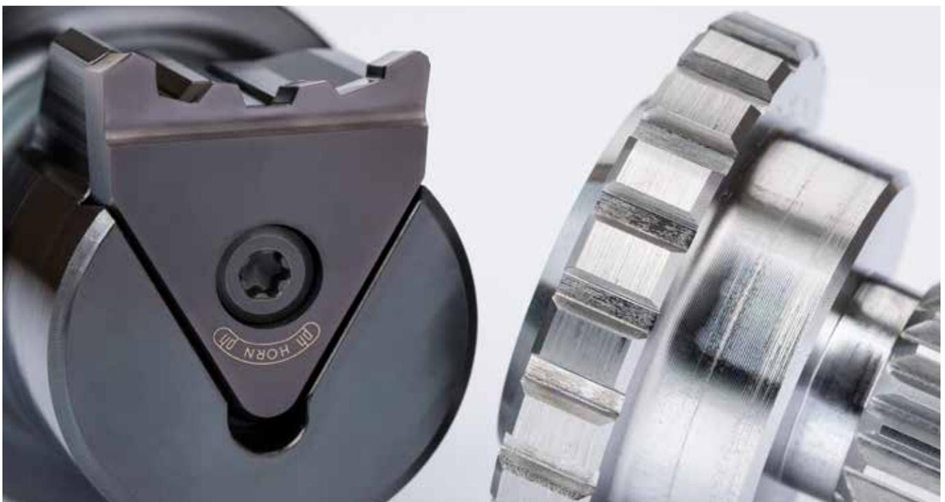
Verzahnungsstoßwerkzeug SH117 mit Vorschneider- und Fertig Zahnprofil zum gleichzeitigen Vor- und Fertigstoßen der Verzahnung.
