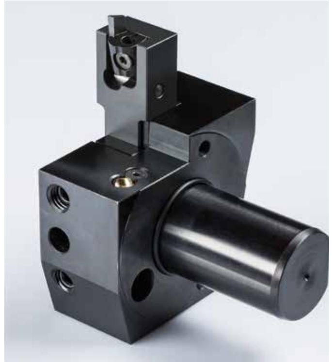
Das Sonderwerkzeug mit der Schneidplatte Typ 231 überzeugt beim Gewindedrehen.
