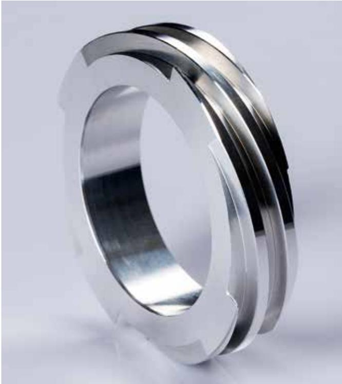
Das fertige Werkstück mit viergängigem Flachgewinde.
