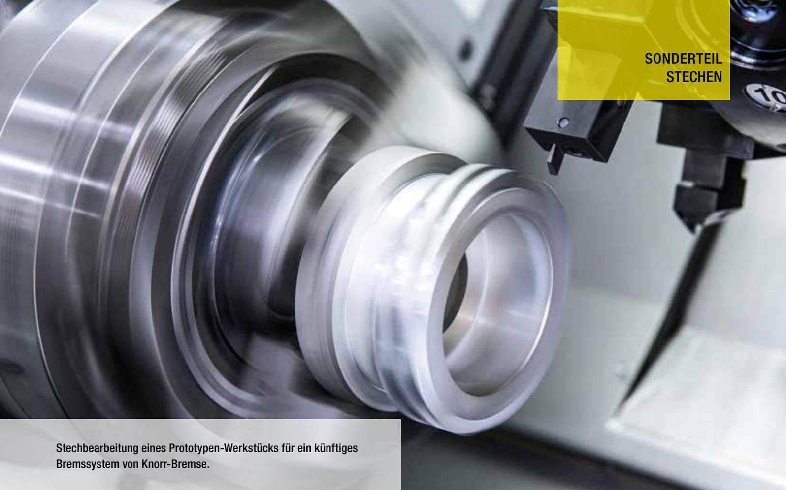
Stechbearbeitung eines Prototypen-Werkstücks für ein künftiges Bremssystem von Knorr-Bremse.
