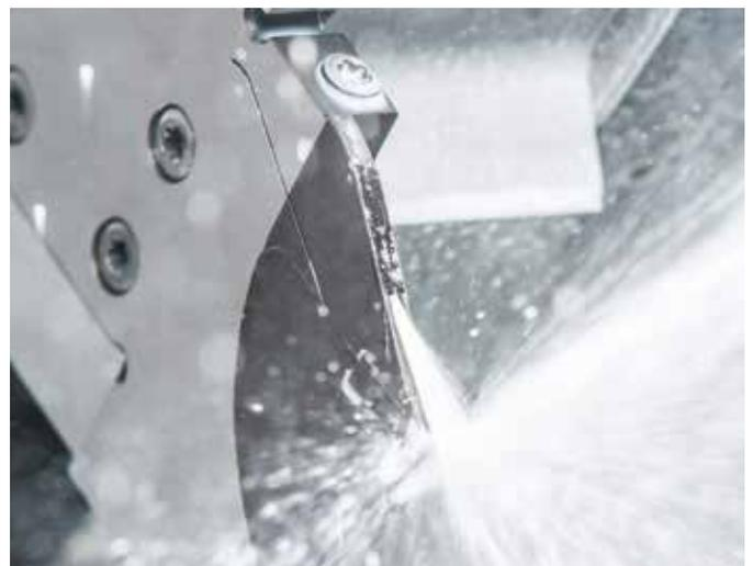
Kassette 845 mit Innenkühlung durch den Spannfinger sowie Unterstützungskühlung von unten.
