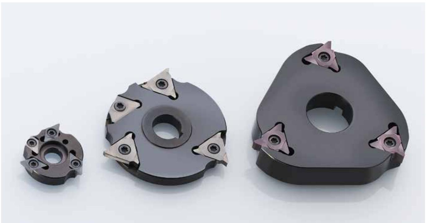
Mit Mehrkantschlagen erzeugt man effizient polygone Flächen am Umfang von Drehteilen.
