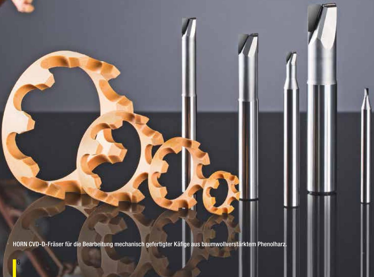
HORN CVD-D-Fräser für die Bearbeitung mechanisch gefertigter Käfige aus baumwollverstärktem Phenolharz.
