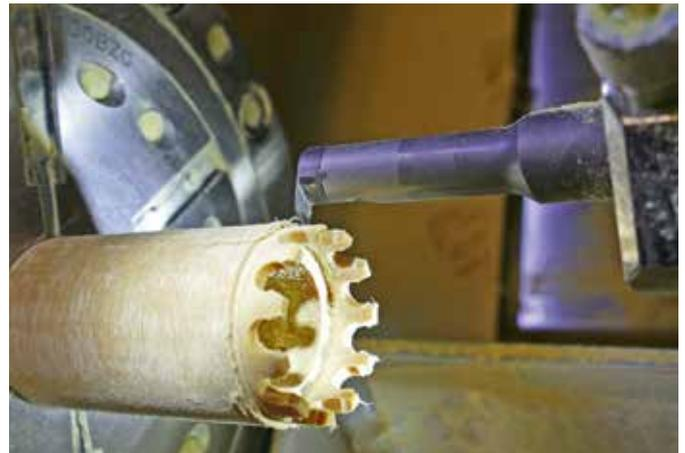
Abstechen des Kugelkäfigs mit einem Sonderwerkzeug aus dem „Mini“-Programm Typ 18P von HORN. Der Schneidstoff des 1 mm breiten Werkzeugs ist CVD-Dickschicht-Diamant.
