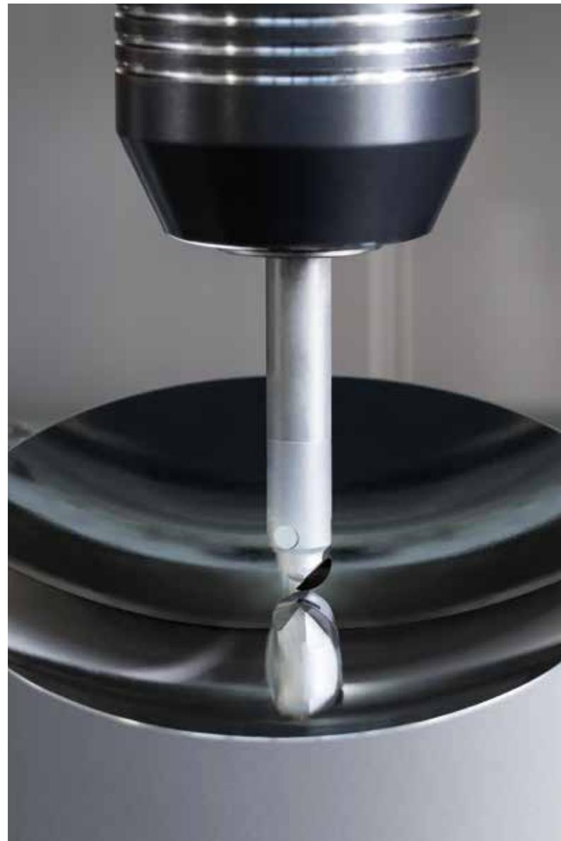
Hochglanzfräsen der konkaven Spiegeloberfläche mit schwingungsdämpfendem Hartmetallschaft aus der Typenreihe 117 und 10-mm-Schneidplatte Typ S117 mit monokristalliner Diamantschneide.
