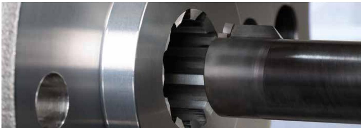
Bei Stoßen der Innenverzahnung steht das Werkzeug S117 auf 12-Uhr-Stellung.
