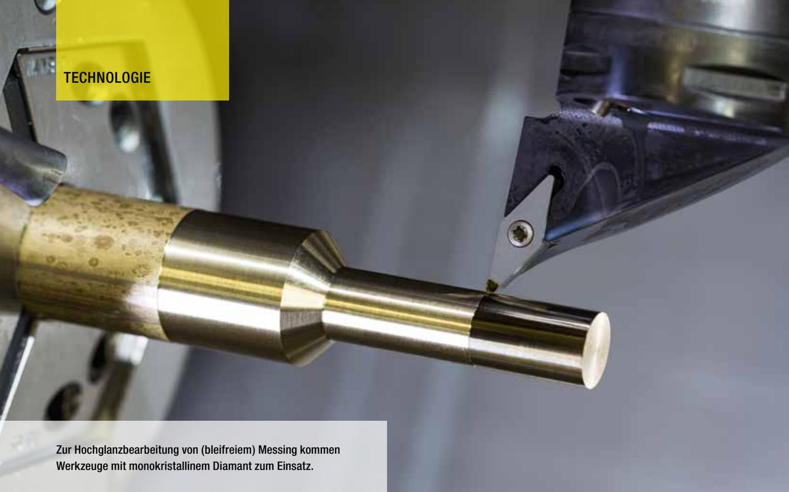
Zur Hochglanzbearbeitung von (bleifreiem) Messing kommen Werkzeuge mit monokristallinem Diamant zum Einsatz.
