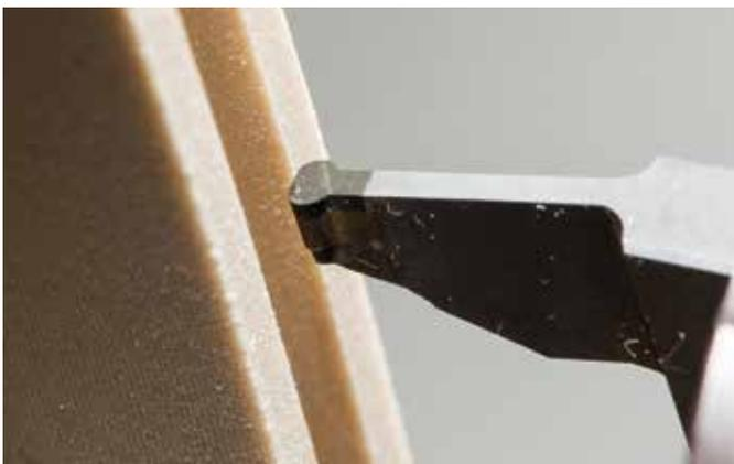
Schneidplatte für die Herstellung der kompletten Innenkontur einer PTFE-Dichtung mit PKD-Schneide. Musste früher die Innenkontur mittels mehrerer spezieller HM-Formplatten dargestellt werden, so reicht heute eine PKD-Formplatte.
