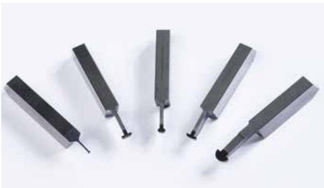
Eine kleine Auswahl der heute verwendeten PKD-Formplatten. CNC-gestützt können damit mehrere Konturvarianten bearbeitet werden. Jede Einzelne ersetzt eine Fülle von speziellen HM-Formplatten.
