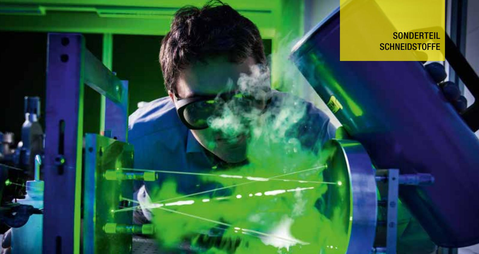
Spiegelsystem aus der Vakuumkammer. Geometrisch exakte Hochglanzoberflächen des planen und des konkaven Spiegels ermöglichen viele Reflexionen eines einmal eingebrachten Terahertzstrahls. Sichtbar gemacht durch einen eingespiegelten grünen Laserstrahl und verdampfendes Kältemittel.
