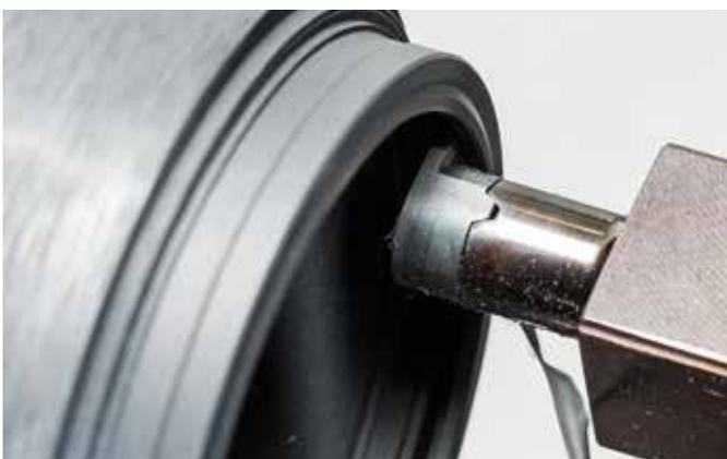
Kleine und mittlere Dichtungsringe werden vom Rohr abgearbeitet. Im Bild die Bearbeitung einer Innenkontur mittels HORN Typ 114 mit PKD-Schneide.
