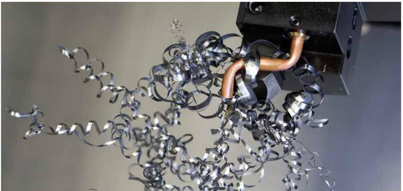
Wirrspäne beim Drehen und Stechen von Aluminiumwerkstoffen sind keine Seltenheit. Mit der neuen Geometrie wird dem entgegengewirkt.
