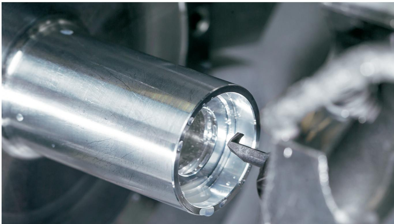
Supermini типа 105 при обработке внутренней канавки шириной 1 мм
