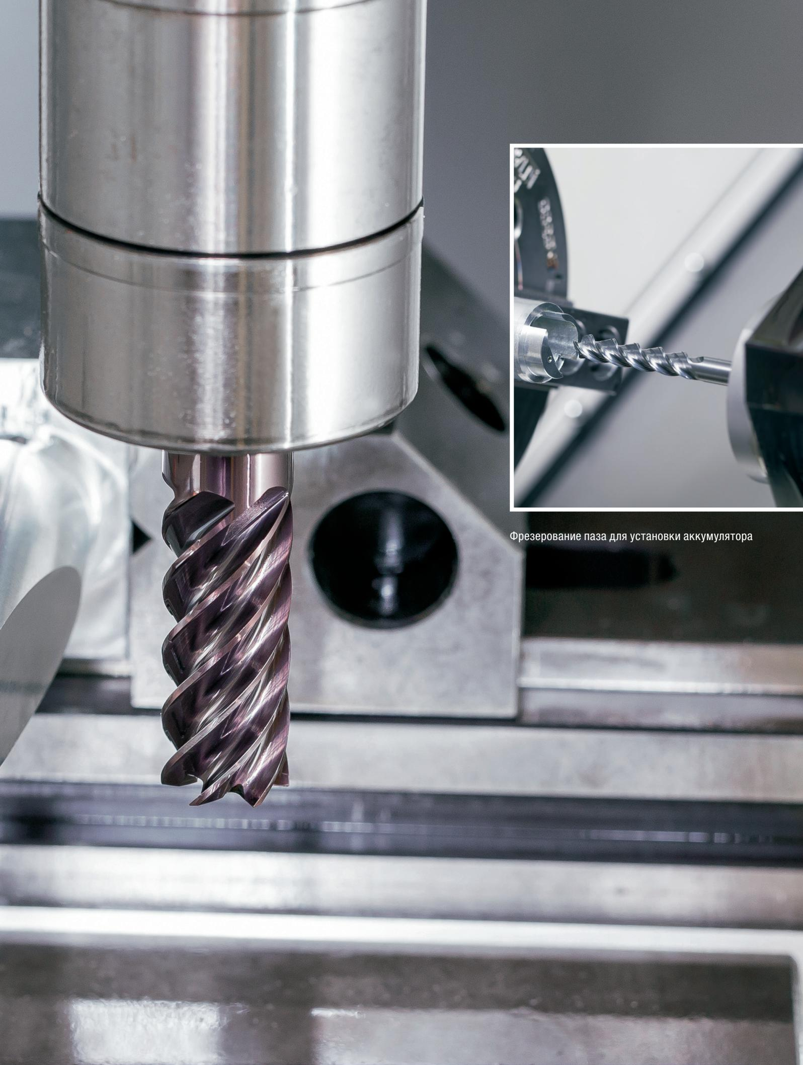
Фрезерование паза для установки аккумулятора
