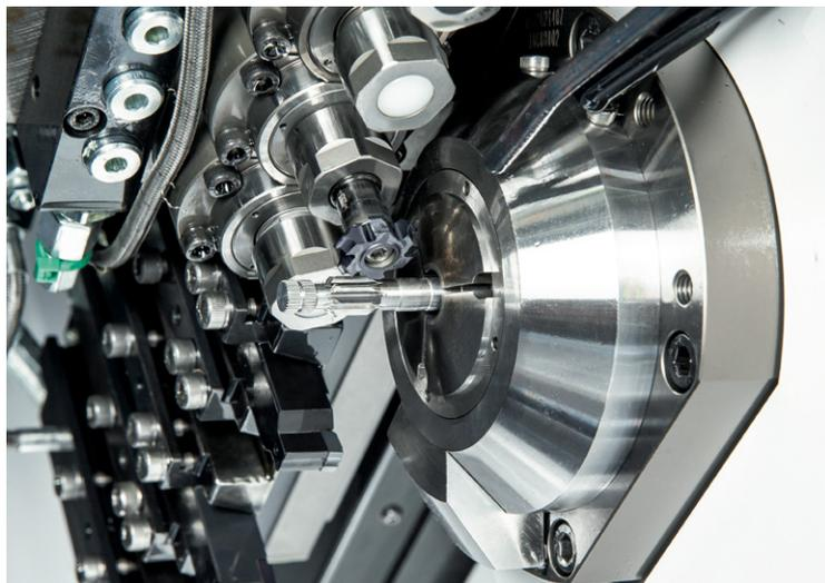
Фрезерование зубчатых колес с использованием системы 613
