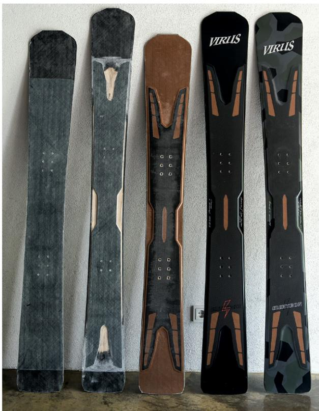
«Кромки пластин из углепластика крайне важны. Любое повреждение или отслоение делают их бесполезными. Мы полностью удовлетворены работой фрезерного инструмента HORN, потому что брак при использовании углепла-
