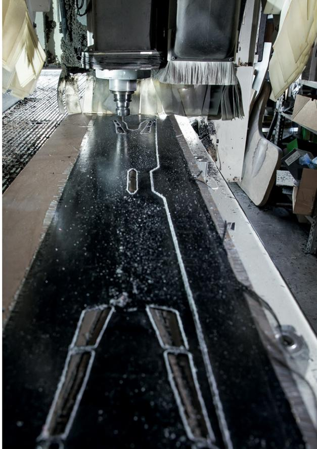
Фрезерование ковриков из углепластика.
