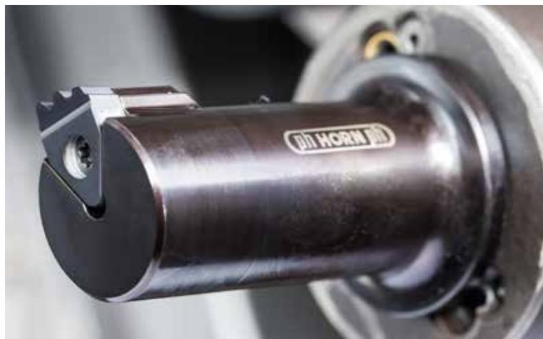
Standard-Schneidplatte aus dem System S117 mit drei Schneiden zum Vor- und Fertigschneiden. Insgesamt 55 Hübe mit je 0,1 mm Zustellung.
