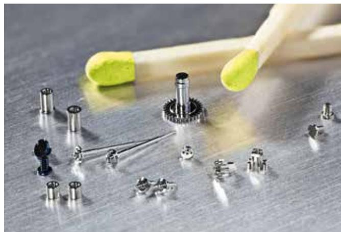
Die präzise Mikrobearbeitung von Wellen, Schraubchen, Hülsen und Zahnrädern im  $\mu$ -Bereich mit optimaler Oberflächenqualität benötigt präzise Schneidwerkzeuge.
