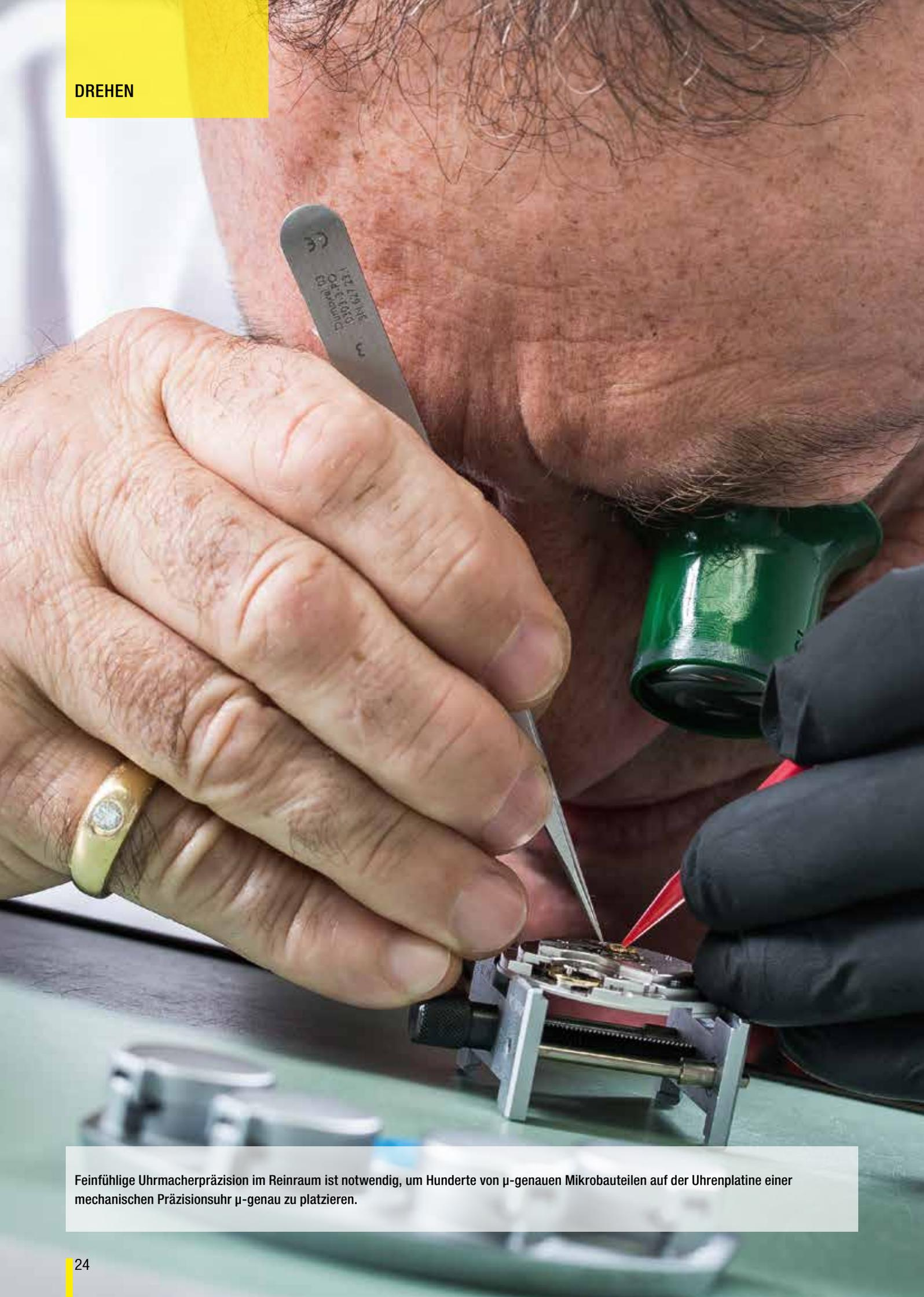
Feinfühliges Uhrmacherpräzisionshandwerk im Reinraum ist notwendig, um Hunderte von  $\mu$ -genauen Mikrobauteilen auf der Uhrenplatine einer mechanischen Präzisionsuhr  $\mu$ -genau zu platzieren.
