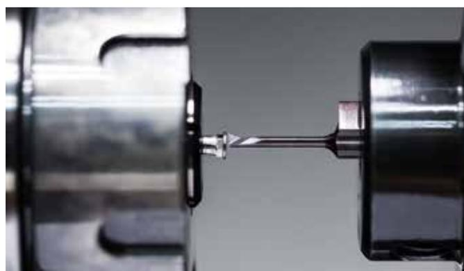
Das variantenreiche Präzisionswerkzeug zur Bearbeitung vieler Uhrteile bei Damasko: Der Supermini Typ 105.
