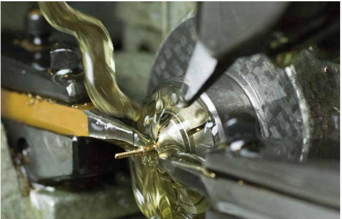
Schrauben, Wellen und andere Bauteile mit kleinsten Durchmesser benötigen spezielle Maschinenkonzepte und Werkzeuglösungen.
