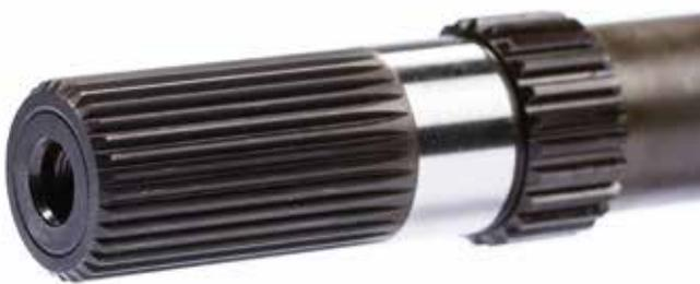
Die Pedalwelle eines elektromotorisch unterstützten Mountainbikes mit Kerbverzahnung und Evolventenverzahnung.
