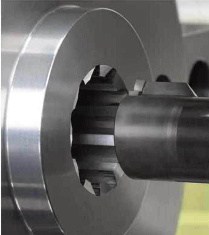
Immer in 12-Uhr-Stellung stoßen und maschinenschonenden Abhebe- und Zustellradius programmieren.
