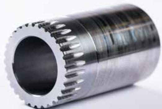
Die sogenannte Kraftmesswelle des Elektroantriebs. 30 Zähne Modul 1 schnell und mit hoher Präzision gefräst.
