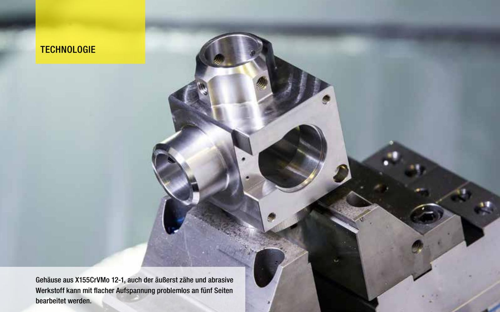
Gehäuse aus X155CrVMo 12-1, auch der äußerst zähe und abrasive Werkstoff kann mit flacher Aufspannung problemlos an fünf Seiten bearbeitet werden.
