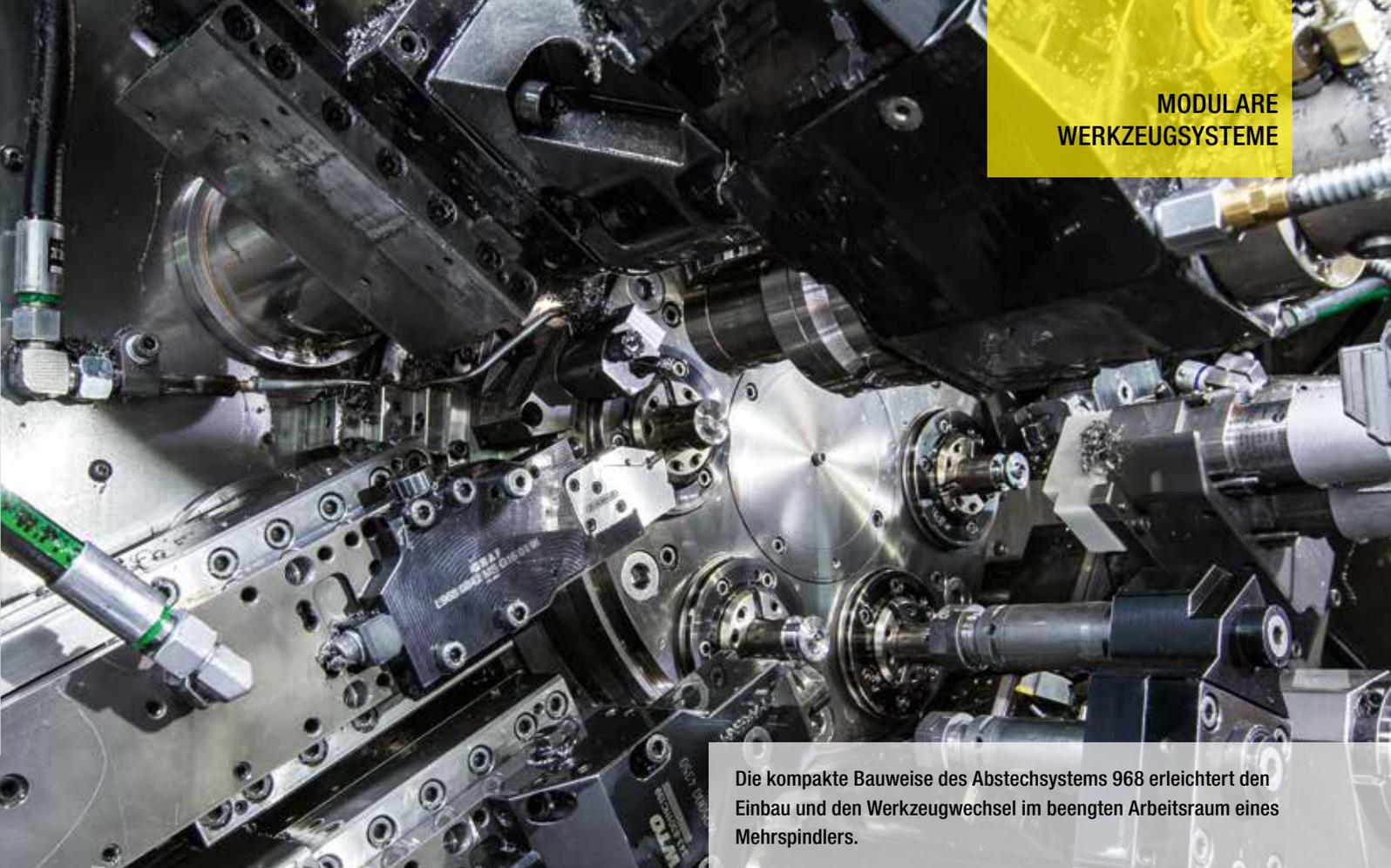
Die kompakte Bauweise des Abstechsystems 968 erleichtert den Einbau und den Werkzeugwechsel im beengten Arbeitsraum eines Mehrspindlers.
