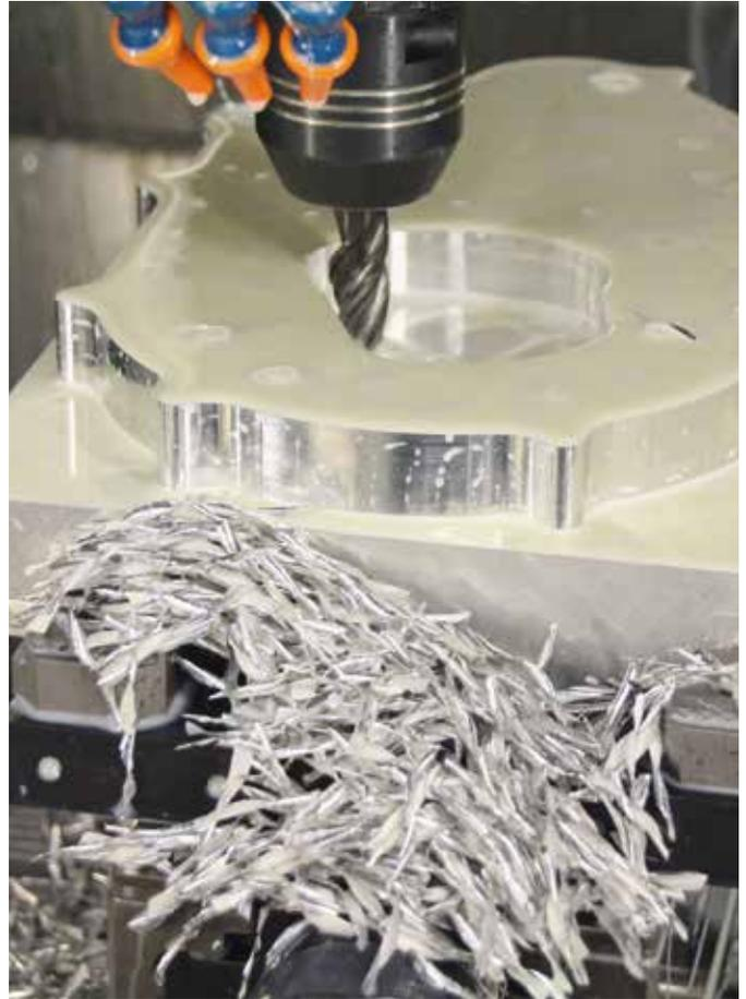
Bei der trochoidalen Bearbeitung im Beispiel wird ein Alublock mit 20 mm Eingriffstiefe zerspannt.
