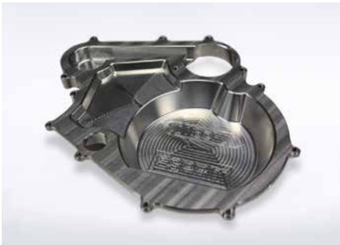
Das fertige Gehäusebauteil wird zum Großteil trochoidal geschruppt.
