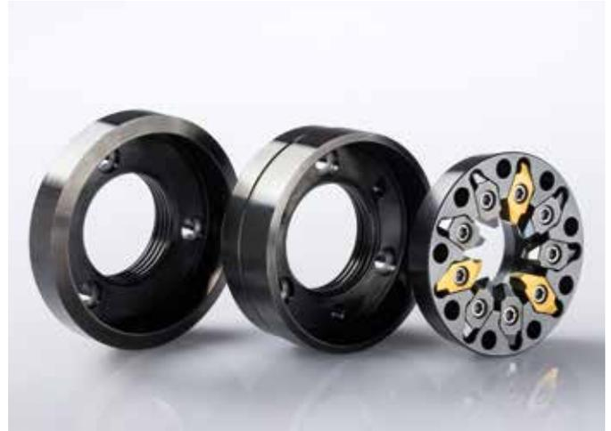
Flexibilität durch modulare Bauweise beim Gewindewirbeln.
