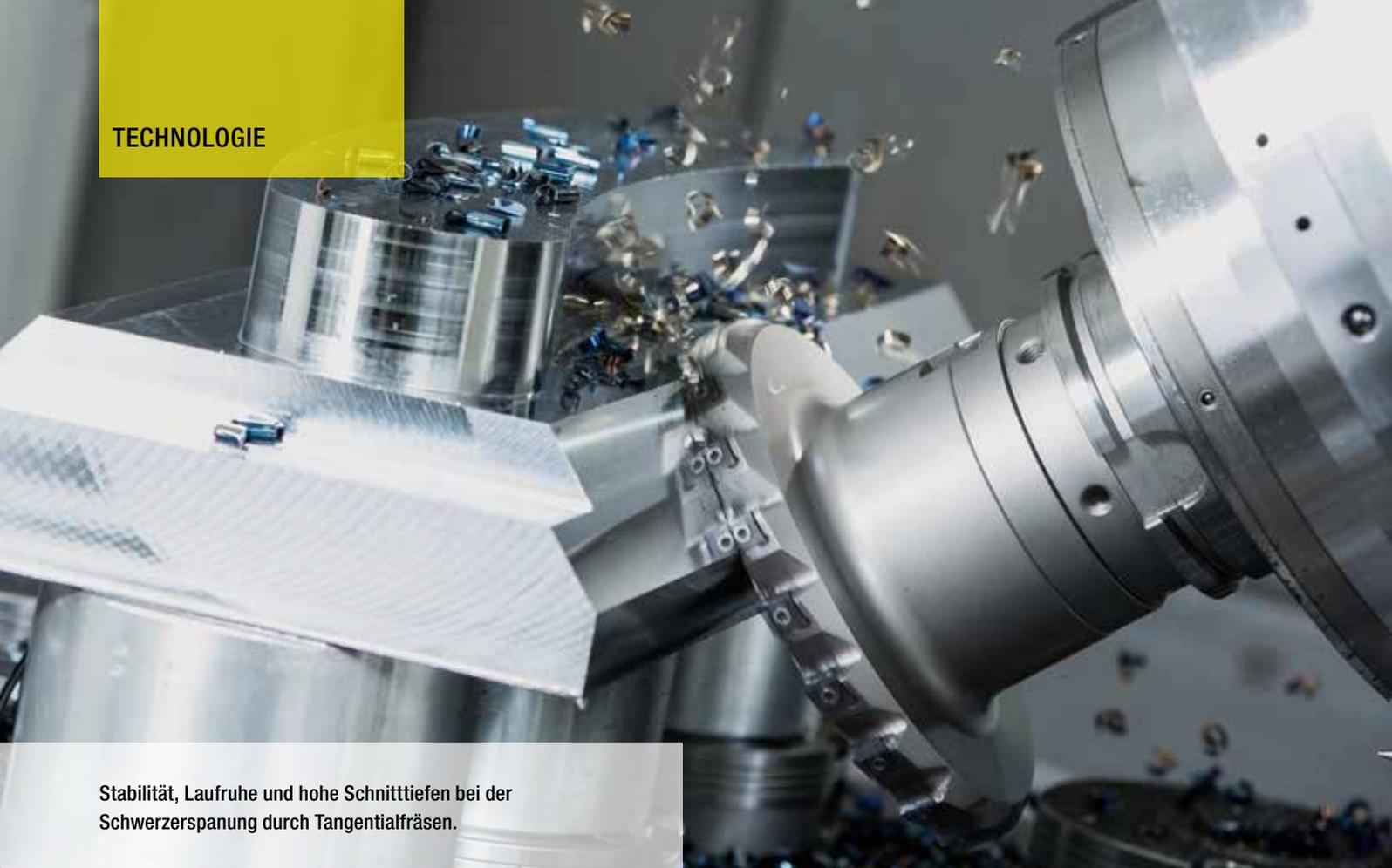
Stabilität, Laufruhe und hohe Schnitttiefen bei der Schwerzerspannung durch Tangentialfräsen.
