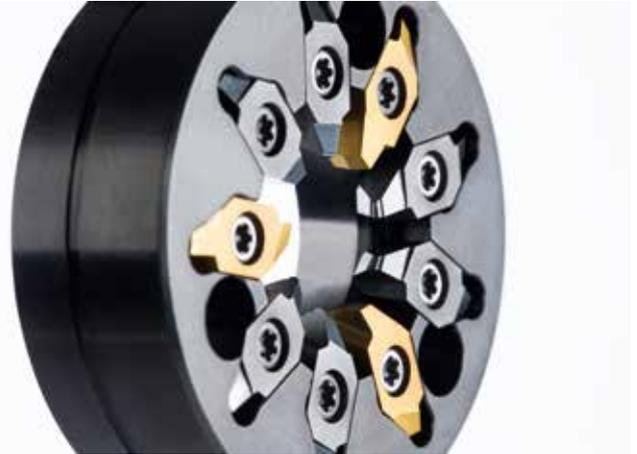
Beim Turbowirbeln mit dem neunschneidigen Wirbelwerkzeug von HORN zerspanen die Vorschneider-Schneiden das Werkstück bis zum definierten Außendurchmesser. Die Schlichtschneiden sorgen für geometrisch einwandfreie Gewindeflanken.
