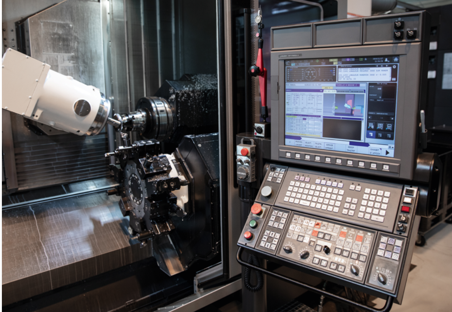
Процесс Skiving можно легко запрограммировать на современных обрабатывающих центрах с ЧПУ
